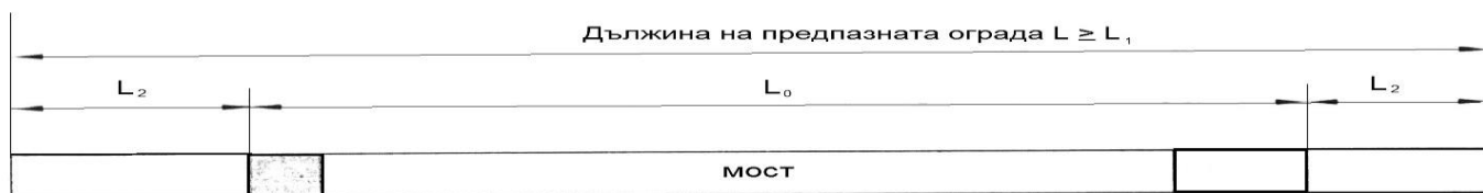
Случай б/: предпазна ограда върху мост с елемент за връзка
