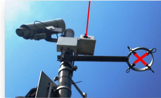
Лазерен сензор за валежи
